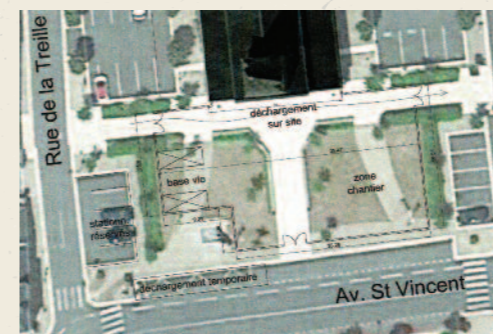
Implantation du chantier
